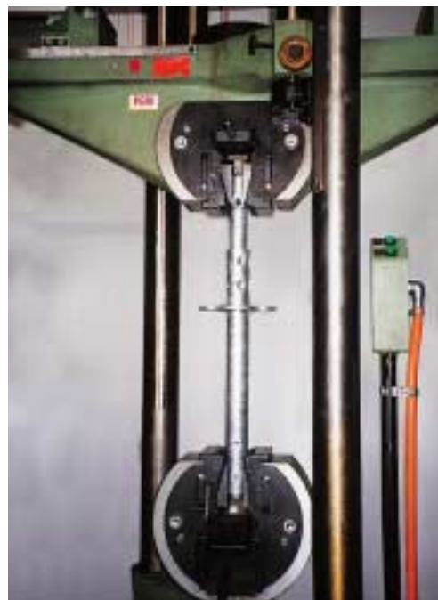
Controlli regolari assicurano l'elevato standard qualitativo dei collegamenti ad innesto PERI. Ciò consente di impiegare componenti di serie anche per la realizzazione di impalcature sospese.
