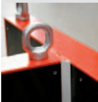
Anello con bullone, punto di presa dell'imbracatura per il sollevamento con la gru, se disponibile, e per la sovrapposizione degli elementi a telaio.
