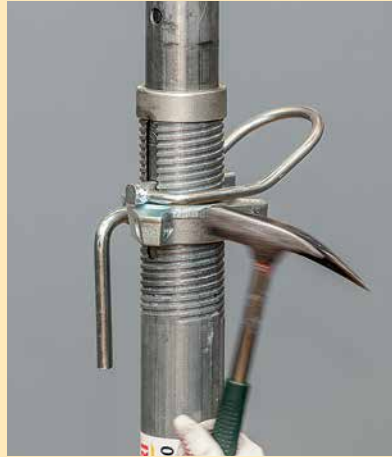
Ghiera con camme da percuotere con il martello che suggeriscono il corretto verso di rotazione per il disarmo del puntello.
