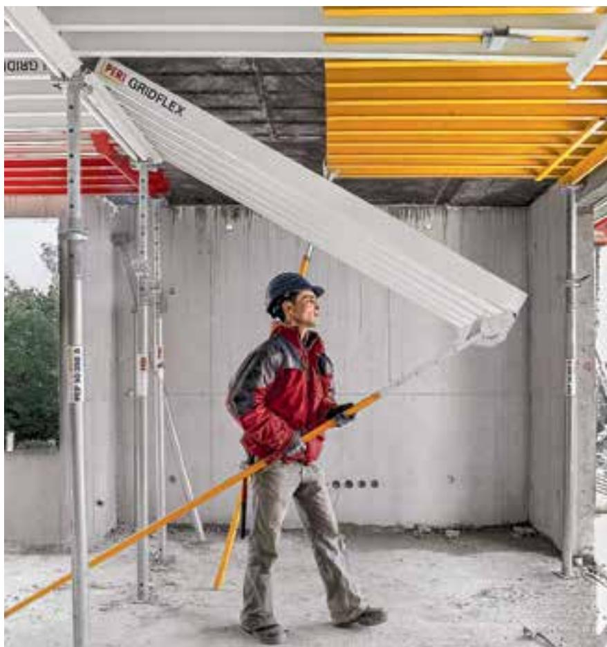
GRIDFLEX è ottimizzato per puntelli per solai PEP / PEP Ergo. In caso di solai con spessori standard (fino a 33 cm) utilizzati nel residenziale, sono sufficienti 0,5 puntelli per m<sup>2</sup> di solaio.
